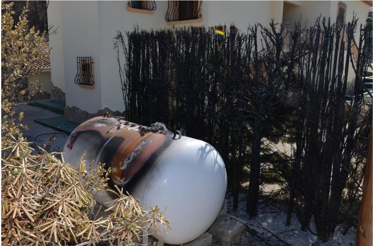
Foto: El riesgo de explosión se incrementa por este tipo de elementos exteriores. Seto de ciprés que afecta a un depósito GLP (Gases Licuados del Petróleo) con el consiguiente riesgo de explosión. Incendio de Xàbia de 2016. Fuente: WUIWATCH.
