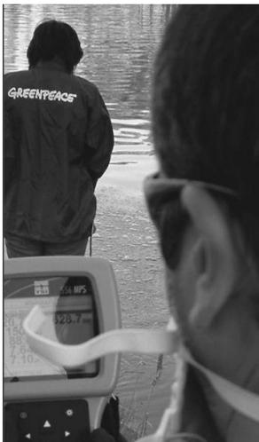
Figura 6. Sonda multiparamétrica YSI 556-02 en plena utilización. Foto: Luís Ferreirim
