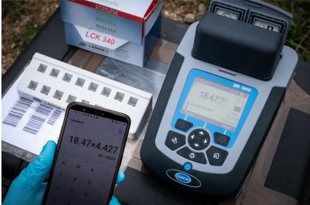
Figura 5. Espectrofotómetro Hach DR1900 en plena utilización. Foto: Pedro Armestre
