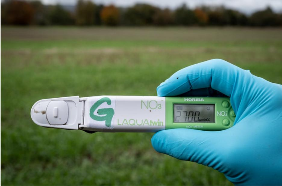
Figura 3. Medidor de nitratos LAQUAtwin-NO3-11. Foto: Pedro Armestre
